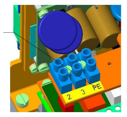
INSIDE GROUNDING TERMINAL FOR 24 V AC/DC
