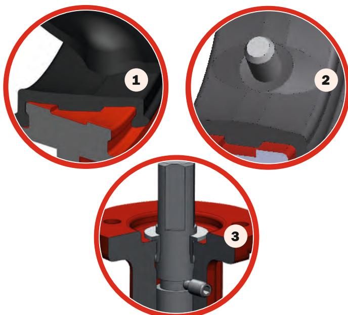
**Třístupeňový systém těsnění** zabezpečuje 100% těsnost a dlouhodobou životnost klapky (až 20 000 pracovních cyklů - mokré, mazlavé médium) a bezpečný provoz i v nejnáročnějších aplikacích.
