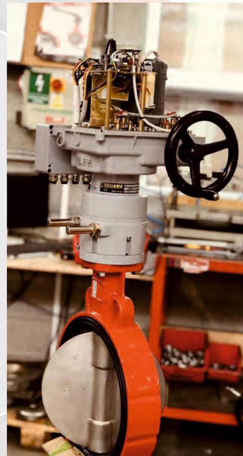
Všechny klapky ABO je možné osadit ručními pákami, šnekovými převody, pneumatickými a elektrickými pohony. Provedení horní příruby dle mezinárodní normy ISO 5211 umožňuje přímou montáž pohonů na klapky. Tímto je zaručena kompatibilita mezi armaturou a pohonem.
