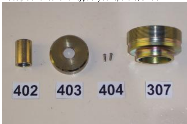
Montáž dorazovej trúbky do priamočiareho adaptéru, SN 5.3.2.2
