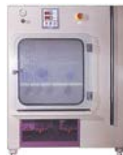
Test in nebbia salina, Salty fog test Salznebel test, Essais en atmosphère saline
